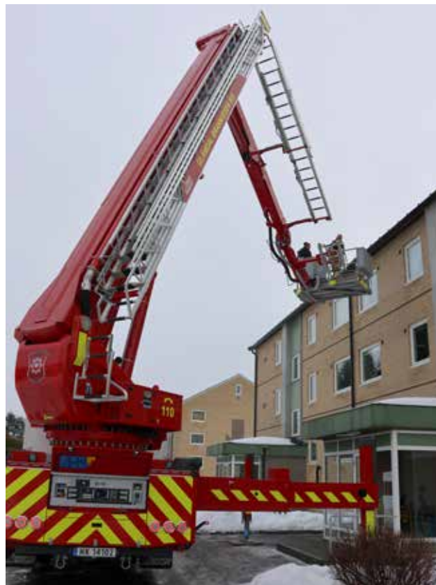
For å kunne kjøre ut stigen på brannvesenets stige bil kreves det et stabilt underlag som tåler trykk på inntil 19 tonn. Her er Bjørnar Berntzen og Patrick Fjell på vei opp til en av leilighetene med den lange stigen.
